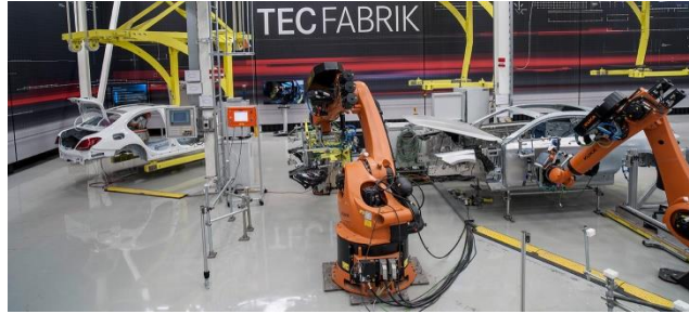
Fig. 17. Braços robòtics cadena muntatge de Mercedes. 40
