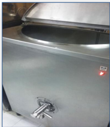
Figura 32: Madurador on es va realitzar la maduració del gelat.
