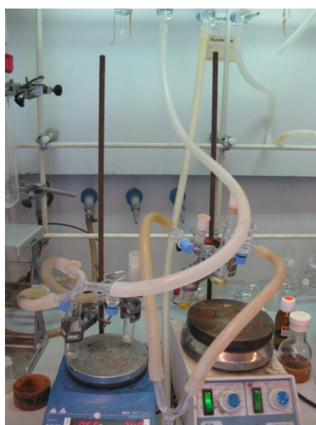
Figura 21. Els 4 matrassos slenck sota l'atmosfera inerta (sense oxigen)
