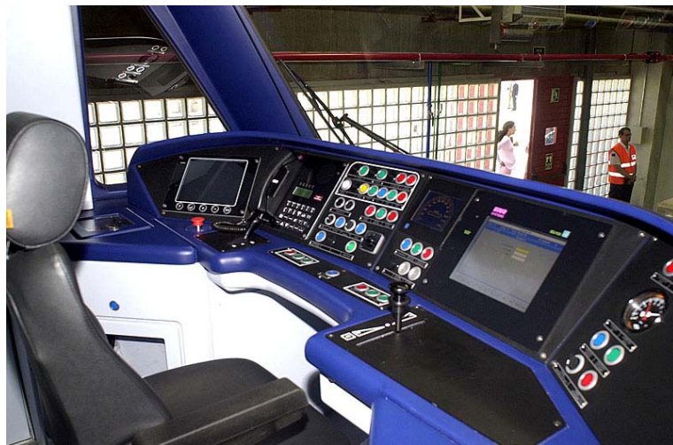
Aquesta cabina de control porta instal·lat el sistema ERTMS.
