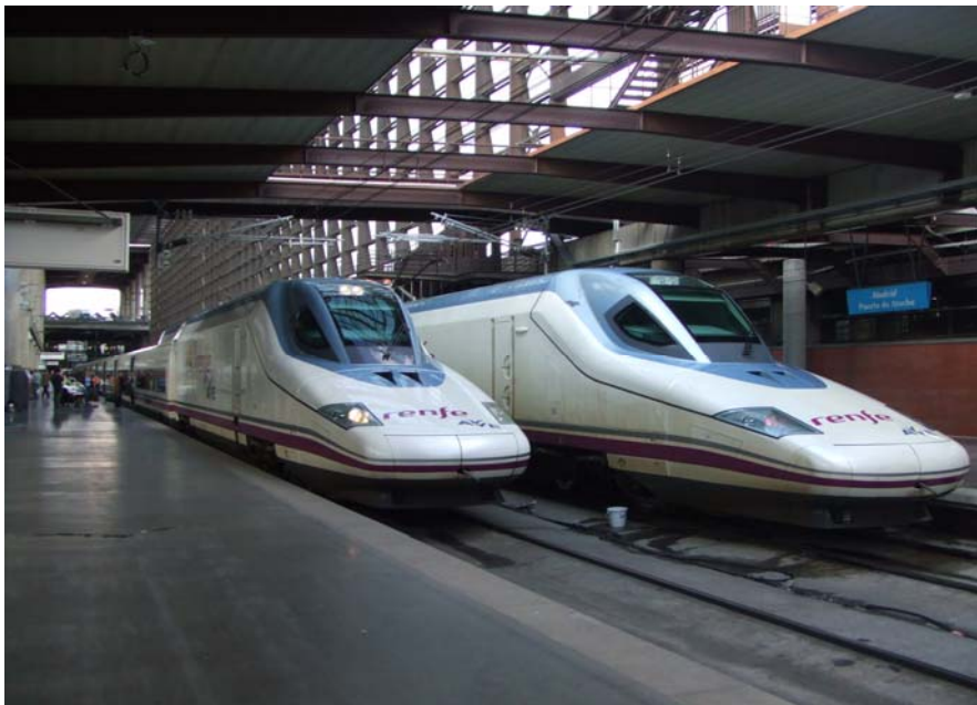
En la foto ens fixem en la forma que se li han donat a aquests ferrocarrils per a que tinguin menys coeficient de fregament
