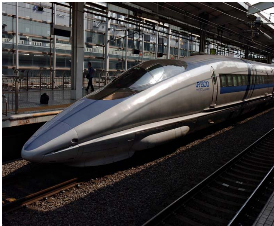
En aquesta foto observem els materials que han utilitzat per al tren: alumini per al recobrint i acer per a l'estructura.
