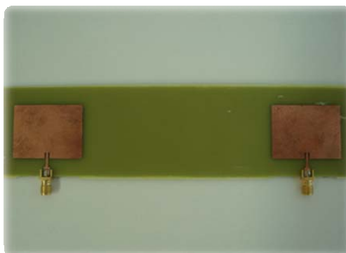
Figura 3.28 Foto física de la antena plana rectangular biestática
