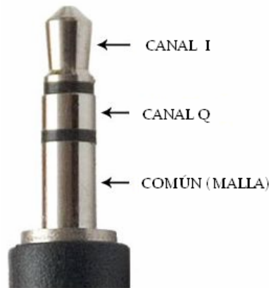
Figura 4.1 Asignación de canales en el Mini-Jack estéreo de adquisición
