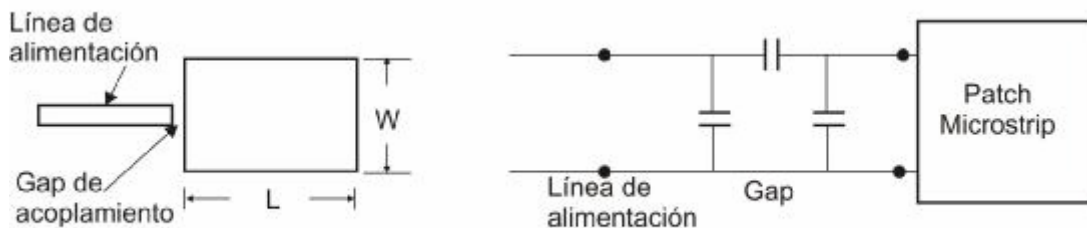
Figura 3.11 Stripline de alimentación con separación (GAP)
