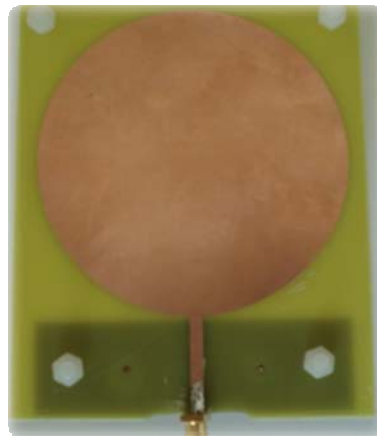
Figura 3.61 Foto física del diseño final (antena plana circular)
