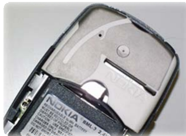
Figura 3.4 Antena microstrip (PIFA invertida) usada para comunicación móvil terrestre
