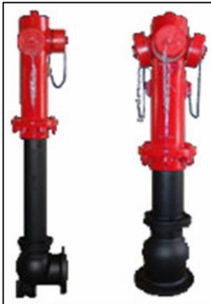
Los hidrantes que se tienen en el la planta son de la marca Anber y el modelo que más cumplía los requisitos de la planta es el *Supertifón*. Este modelo es de columna seca para evitar que se hiele el agua que contiene en la columna en invierno. Dispone además de las bocas de salida inclinadas para evitar el colapso de mangueras, cierran con perfecta estanqueidad y dispone de un sistema antirrotura por el que, en caso de impacto, rompe la unión con el cuerpo liberando al obturador.
