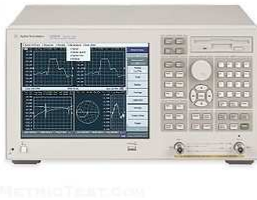
Figura 4.3. Vista frontal de l'analitzador de xarxes Agilent E5062A
