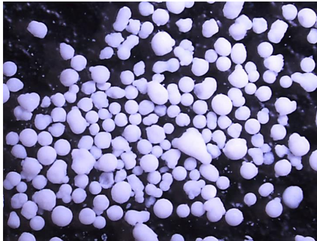
Figura 8. Imatge presa al microscopi òptic de partícules de Sipernat 2200 amb un augment de la lent de x2,0.
