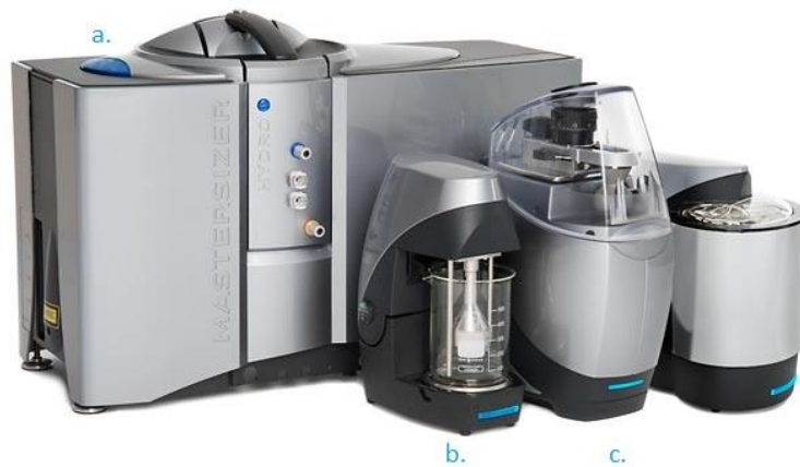
Figura 5. Imatge del equip de treball amb els seus accessoris: a. Mastersizer 3000, b. Hydro EV i c. Aero S.
