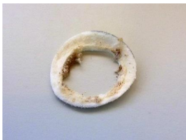
Fig. 5.5.4.1. Filtre de cel·lulosa cremat per àcid sulfúric.
