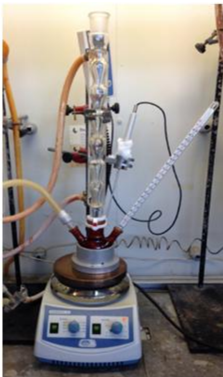
Figura 9. Muntatge reacció amb escalfament convencional
