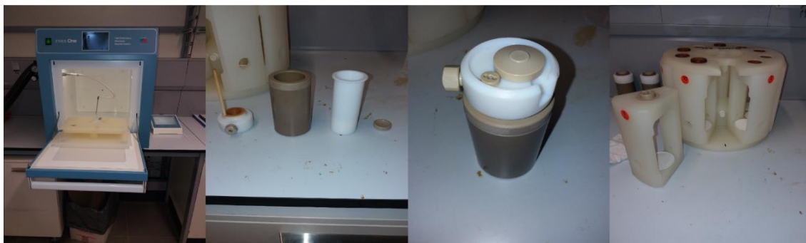
Figura 5.1. Fotografia de l'equip utilitzat pel mètode de síntesi solvotermal. D'esquerra a dreta es veu a) el forn de microones; b) el vas de tefló (blanc) i el sensor de temperatura a l'esquerra; c) l'aspecte del autoclau tancat i c) el suport sobre el que s'ajusta l'autoclau.
