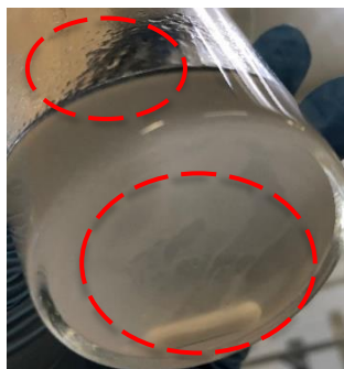
Imatge 4 Mostra de l'exp. 6 extreta per realitzar una titració on s'observa que no es soluble amb la n-dibutilamina.
