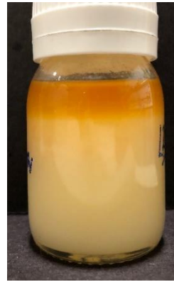
Imatge 6 Mostra de l'exp. 7 abans de netejar el reactor, diferenciació de dues fases, una taronja i l'altre blanquinosa.
