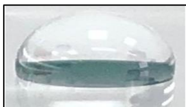
Imatge 23 Prova hidrofòbia exp. 3.
