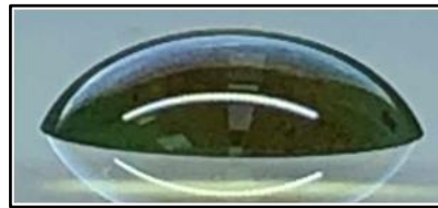
Imatge 35 Prova oleofòbia exp. 8.
