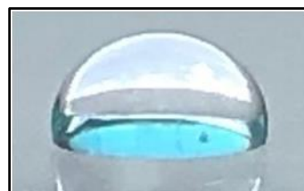
Imatge 22 Prova hidrofòbia exp. 2.
