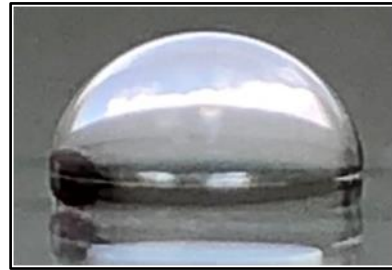
Imatge 28 Prova hidrofòbia exp. 10.
