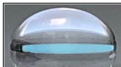
Imatge 24 Prova hidrofòbia exp. 4.
