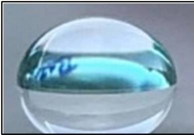
Imatge 27 Prova hidrofòbia exp. 9.
