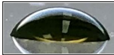
Imatge 37 Prova oleofòbia exp. 10.
