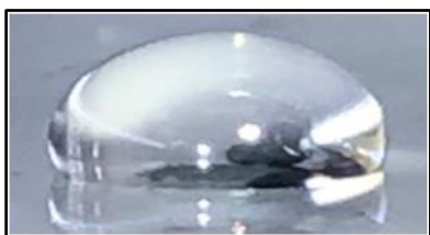
Imatge 21 Prova hidrofòbia exp. 1.
