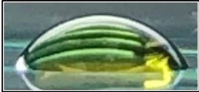
Imatge 32 Prova oleofòbia exp. 3.
