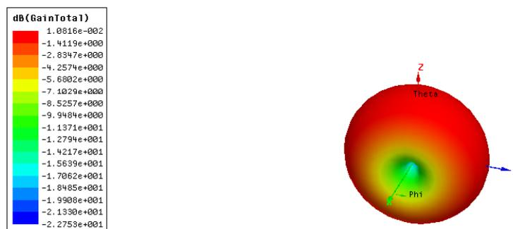
Fig. 4.46 Campo electromagnético tag adaptado sin material
