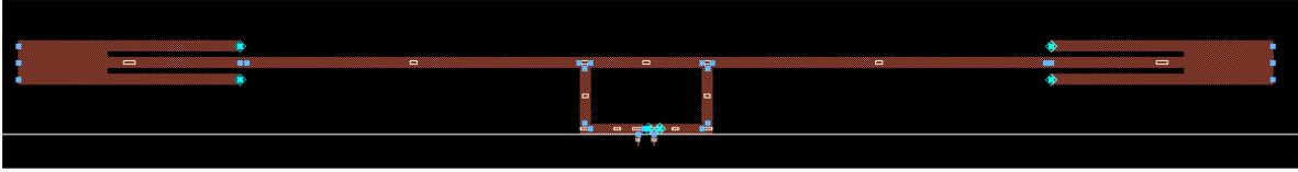
**Fig. 4.1** Diseño tag de 32 mil adaptado con capa de aire (tag 1 y 2)
