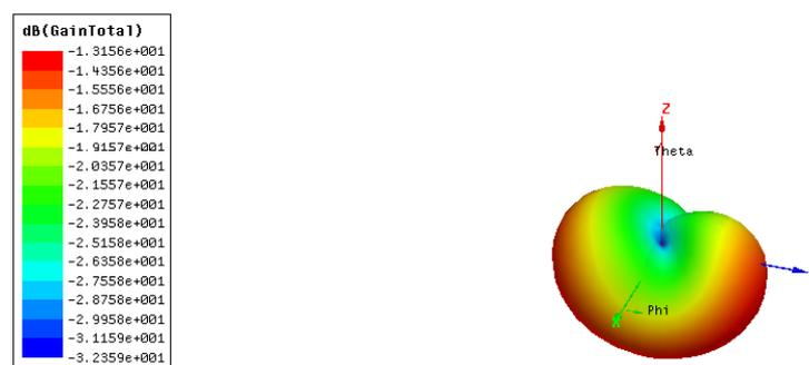
Fig. 4.47 Representación campo electromagnético tag de 32 mil de sustrato
