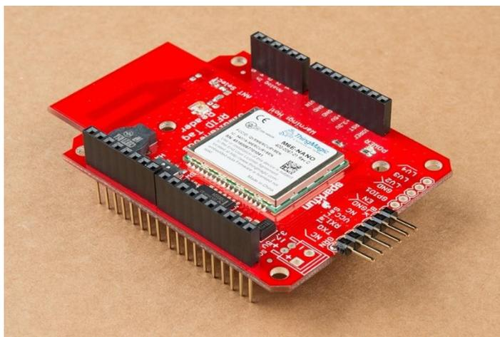
**Figura 17.** SparkFun Simultaneous RFID Reader - M6E Nano, “*shield*” compatible con Arduino
