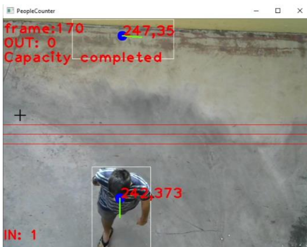
Figura 24. Detecció de una persona entrant en l'aplicació de C++.
