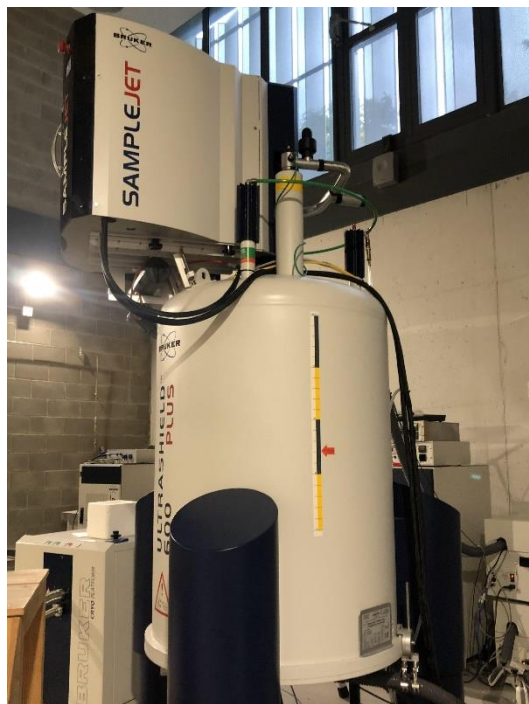
Figura suplementària 2. Eespectròmetre “Bruker Avance III-600”. Opera a 600,2 MHz. Utilitzat en totes les mesures.
