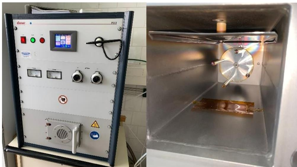
Figura 19. Diener. Sistema de plasma de baja presión.
