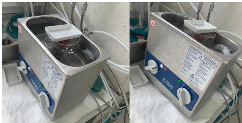
Figura 15. Bandelin SONOREX. Sonicador utilizado para el revolviendo de la tinta.
