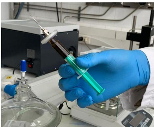
Figura 16. Montaje de la jeringuilla, filtro y aguja para la introducción de la tinta en el cartucho.
