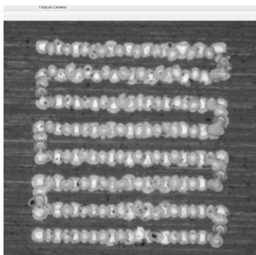
Figura 29. Resultado de la impresión en forma discontinua.
