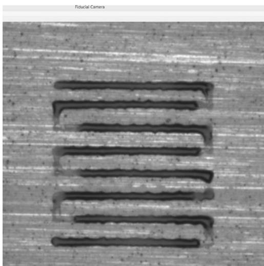
Figura 26. Resultado de meandro con técnica discontinua.
