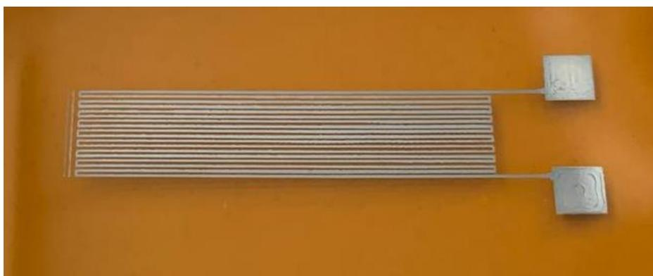
Figura 35. Resultado final de la impresión de la galga extensiométrica.
