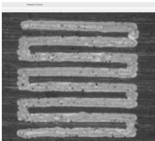
Figura 30. Resultado de la impresión en forma continua.
