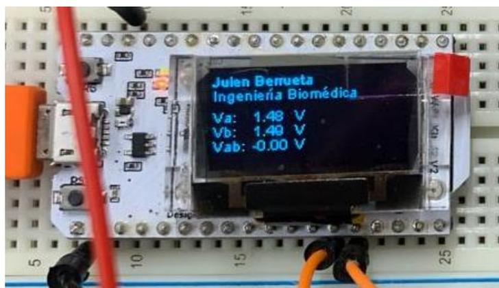
Figura 50. "Display" de la placa ESP32 mostrando los datos obtenidos del puente de Wheatstone.
