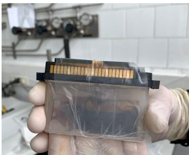
Figura 13. Cartucho relleno de una suspensión de nanopartículas de Ag.
