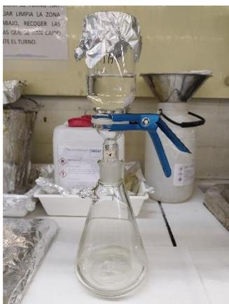
Figura 8. Montaje para la microfiltración del THF.
