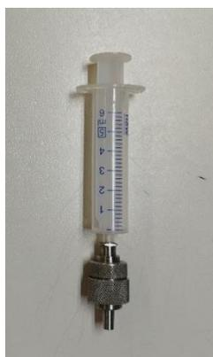
Figura 11. Jeringuilla con filtro de membrana
