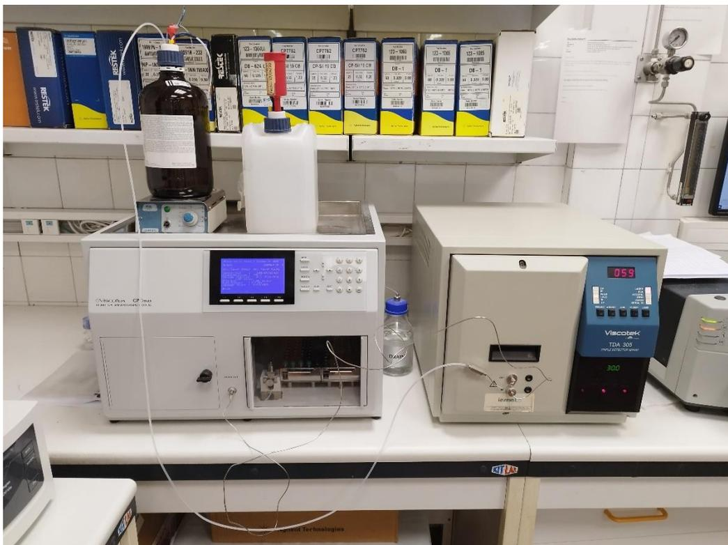
Figura 4. Equipo de la GPC con sus respectivos módulos, botella de eluyente y garrafa de residuos.
