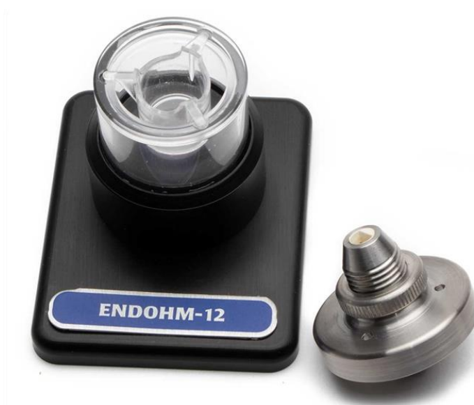
Figura 21 Electrodo ENDOHM-12 EVOM™ para medición de TEER en insertos 12 mm [20]
