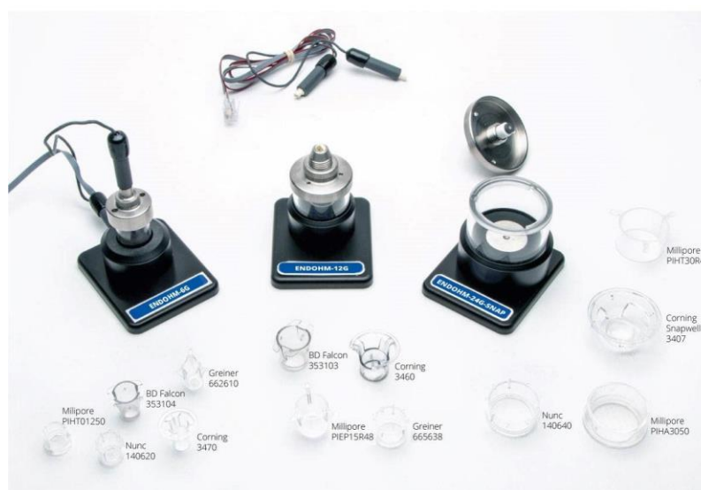
Figura 20 Electrodo ENDOHM EVOM™ para medición de TEER en insertos de 6.5 mm, 12 mm y 24 mm [20]
