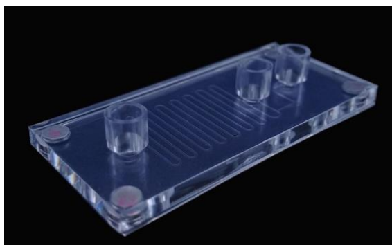
Fig. 18 – Dispositivo microfluídico de policarbonato. Extraído de [40].
