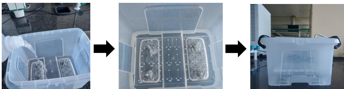
Fig. 58 – Proceso de tratamiento superficial con acetona.
