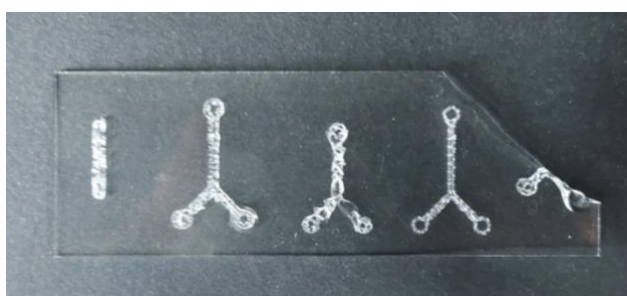
Fig. 96 – Microcanales fallidos en vidrio.
