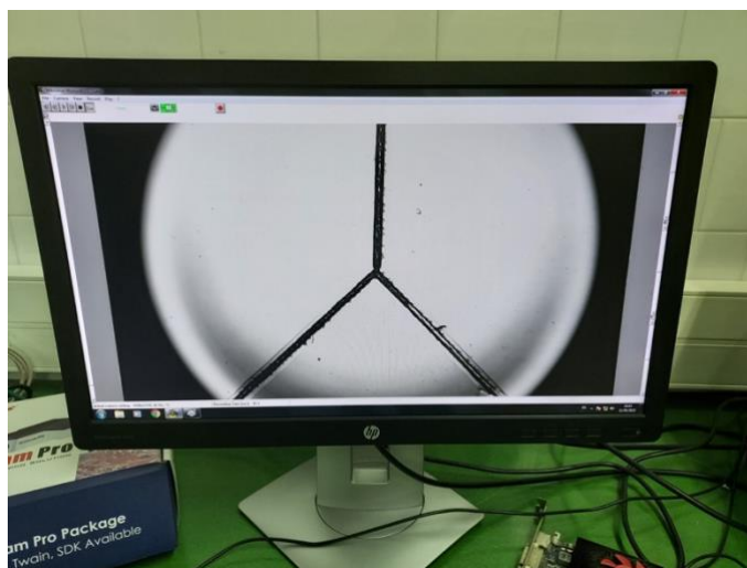
Fig. 52 – Imagen de un microcanal utilizando el software de la cámara del microscopio.
