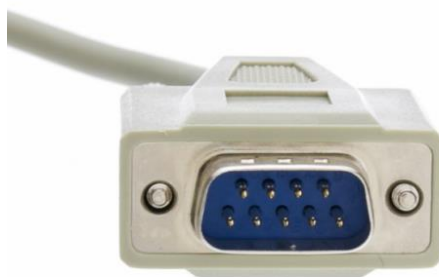
Figura 6. Aspecte d'un connector RS-232.
