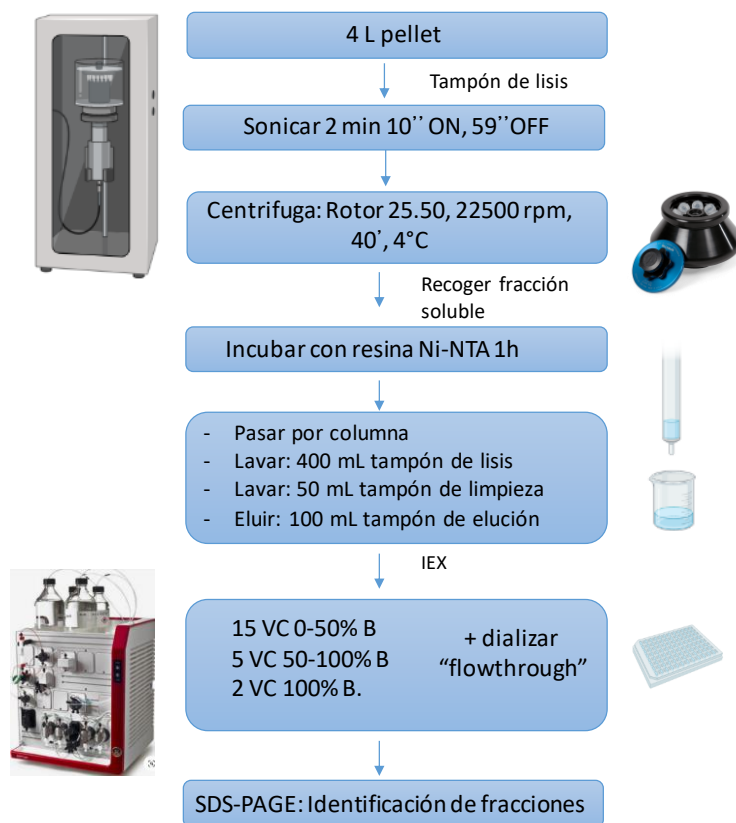
Figura 7. Esquema del procedimiento para la purificación de TEV.
