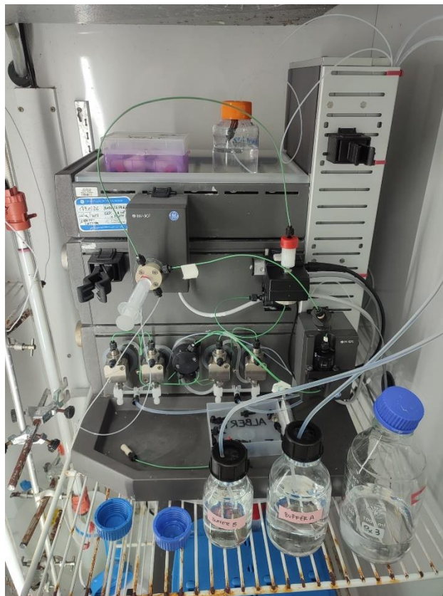
Figura 3. Equipo de cromatografía Äkta con columna de intercambio catiónico HiTrap SP HP 5 mL.
