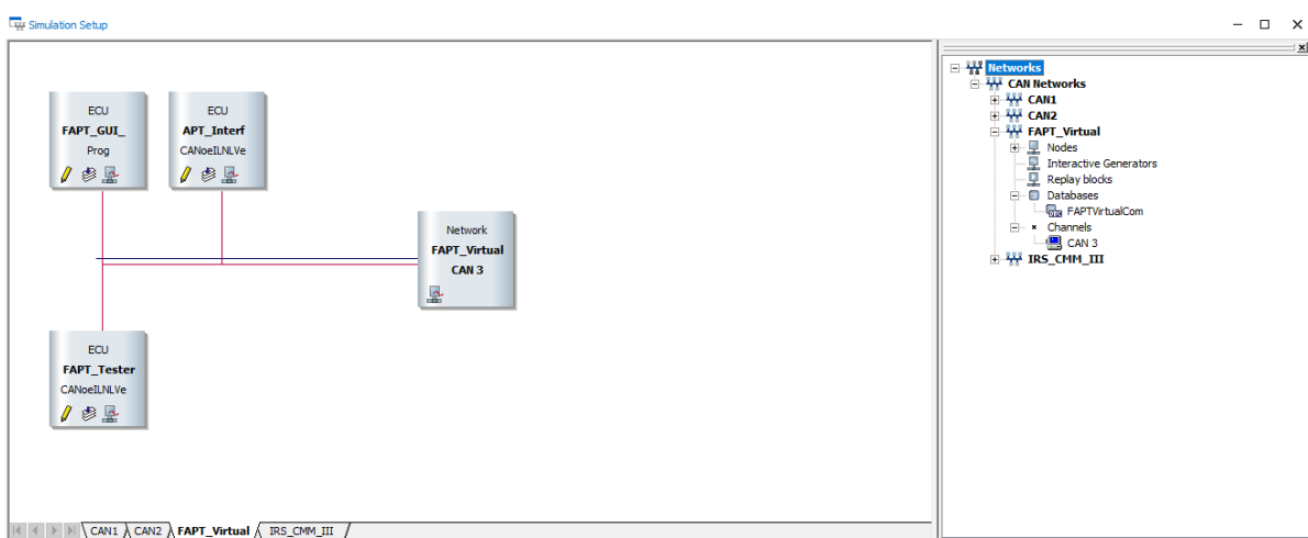
Il·lustració 47. Captura de la finestra simulation setup de la integració del FAPT en el projecte utilitzant el CAN virtual.
