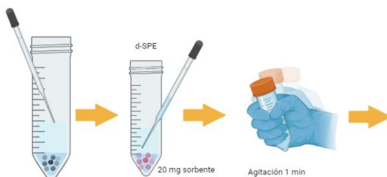
Figura 3. Procedimiento de clean up de la muestra mediante d-SPE
