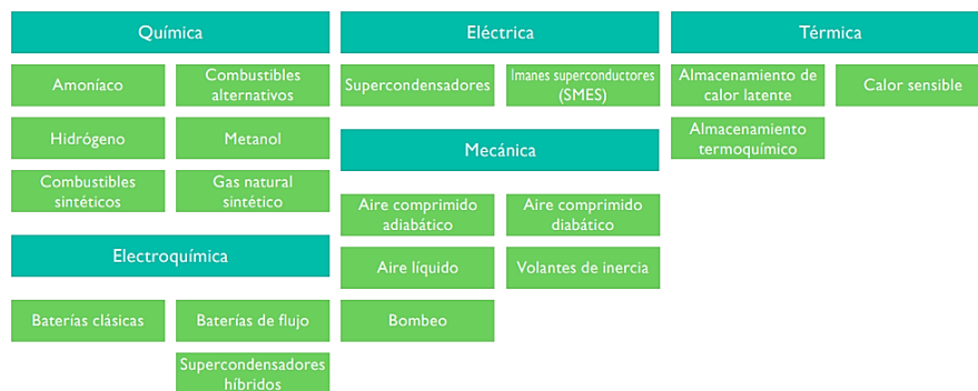
Figura 14. Clasificación de las tecnologías de almacenamiento energético [5] .
