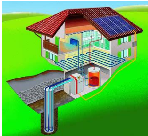
Figura 9. Esquema energía geotérmica de baja temperatura.
