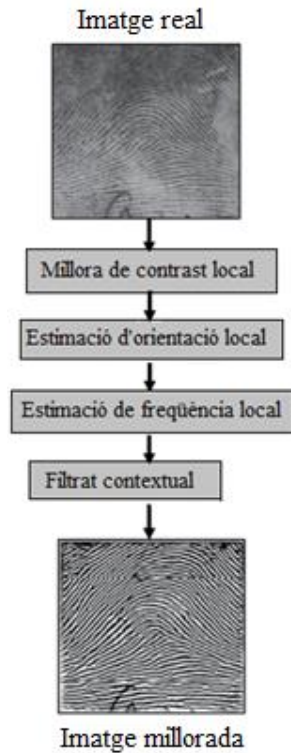
Figura 21. Etapes d'un algoritme de millora de la imatge de l'empremta dactilar. Font de la referència 8 .
