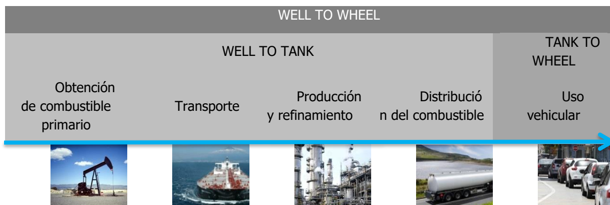
Figura 36. Esquema del concepto "Well to Wheels" (WTW) en relación con los vehículos de MCI
