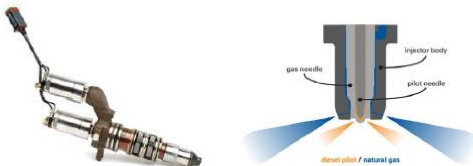
Figura 9. Detalle inyector HPDI. Fuente WESTPORT.
