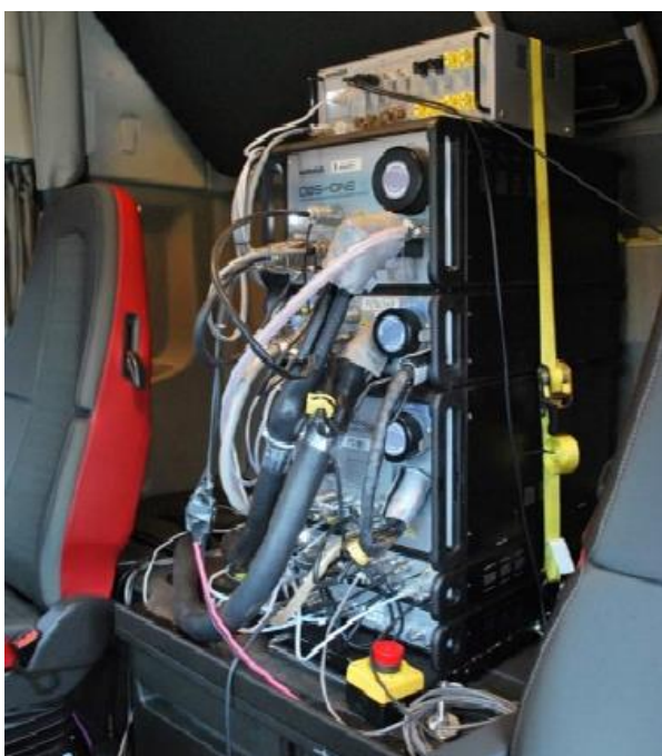
Figura 13. Equipos PEMS. Fuente TNO.
