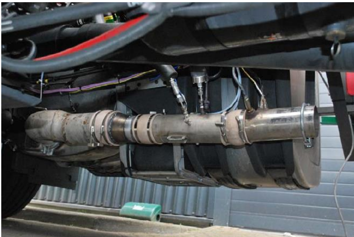
Figura 14. Instalación sensores en el escape. Fuente TNO.
