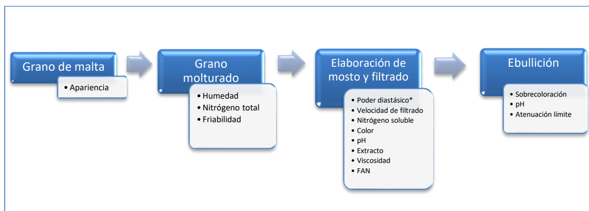
Gráfico 3: Esquema del desarrollo de los ensayos. (* indica que la preparación del mosto para este ensayo difiere del resto).
