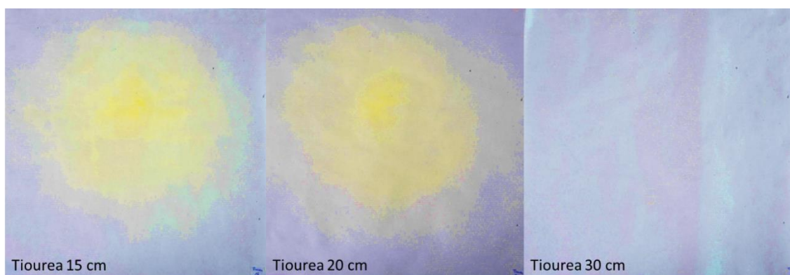
Figura 17. Resultats obtinguts de la reacció colorimètrica de la tiourea amb el bismut (III) present en el GSR.
