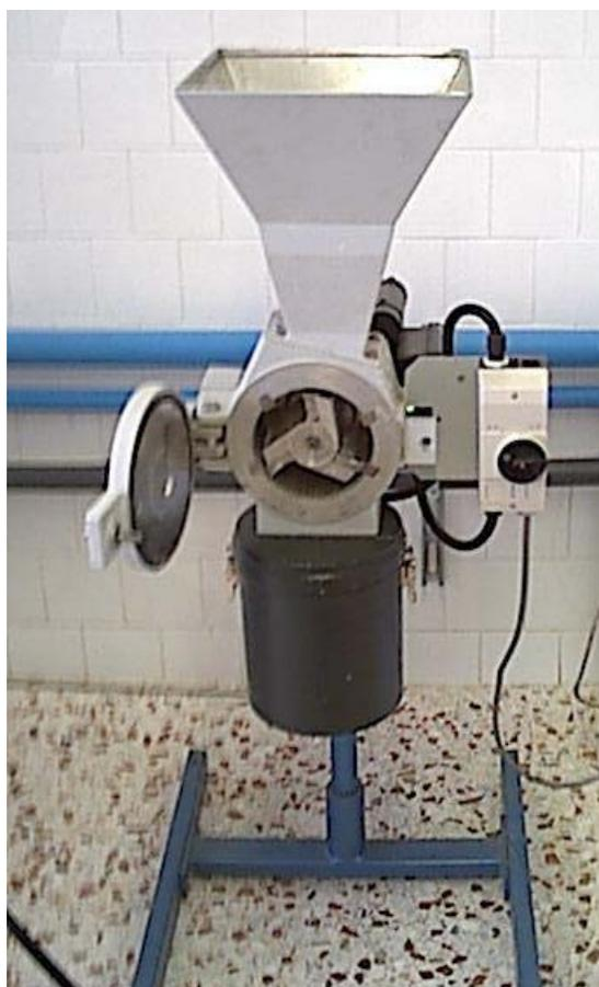
**Figura 6. Molino de cuchillas Retsch**
