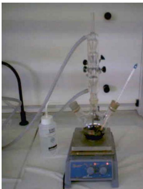
**Figura 5.4**: Reactor de vidrio utilizado para preparar lignina hidroximetilada (ML) y la resina fenol-formaldehído (PF).
