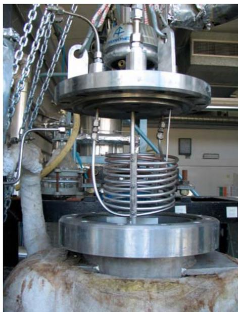
Figura 8.1: Foto del reactor utilizado para despolimerizar la lignina.
