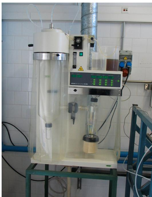
**Figura 5.2 :** Secador a pulverización en pleno funcionamiento “*Spray drier*”.
