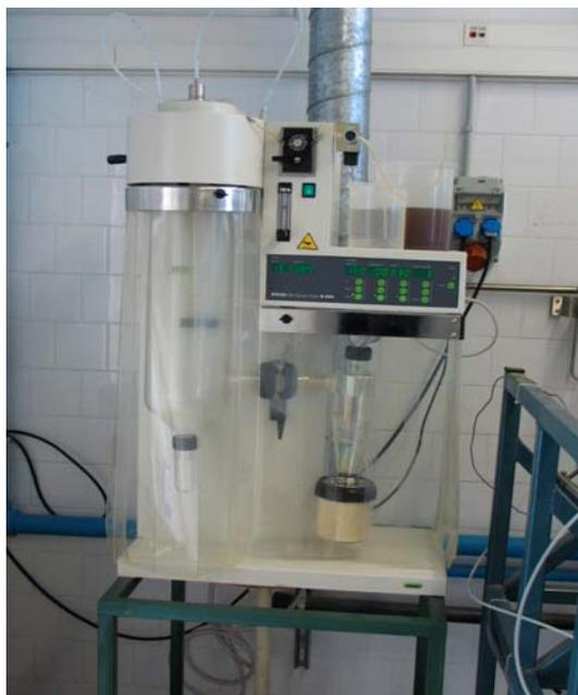
**Figura 8.2:** Secador a pulverización en pleno funcionamiento Spray dryer”.
