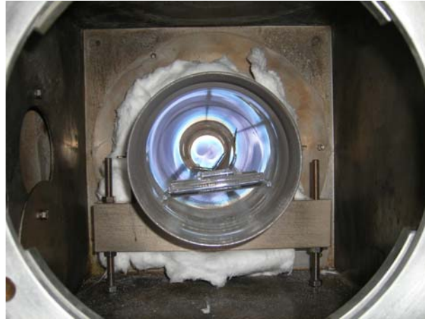
Figura 12. Foto de la boca del horno utilizado para calentar las obleas de c-Si.
