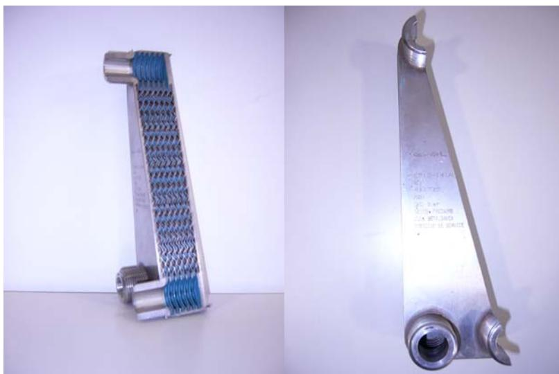
Figura 2.4 Sección de un intercambiador de placas tipo CB14.
