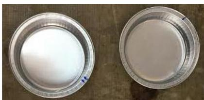
Figura 7.11 Cápsulas con 10ml de solución para determinar la concentración
