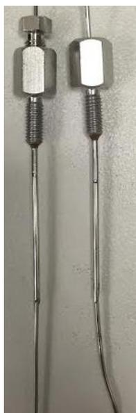
Figura 7.9 A la derecha la nueva aguja de inyección y a la izquierda la anterior torcida.
