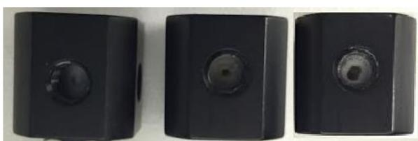
Figura 7.7 izquierda: válvula en perfectas condiciones. Centro: válvula en mal estado. Derecha: válvula después de limpiar con acetona.
