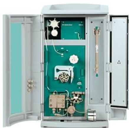
Figura 6.6 Equipo de cromatografía de exclusión iónica
