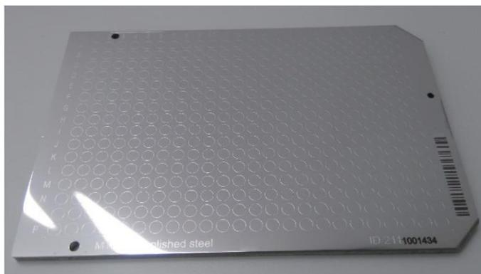
**Figura 18: Placa metálica de disposición 24x16 (384 pocillos)<sup>50</sup>.**
