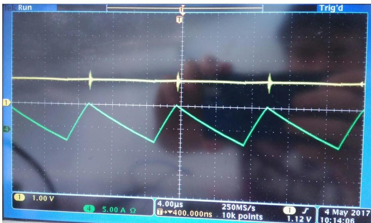
Figura 57. Resultados obtenidos del convertidor *buck* con un ciclo de trabajo del 25% de las señales de tensión de salida (amarillo) y corriente de la bobina (verde).
