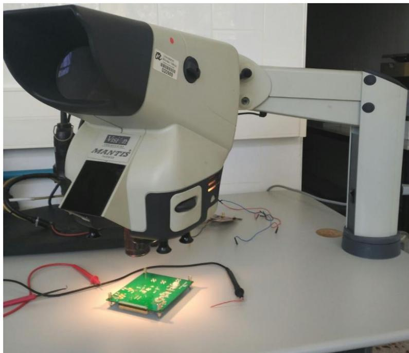
Figura 34. Lente de aumento Mantis utilizada para la soldadura sobre el kit de evaluación del ADC.
