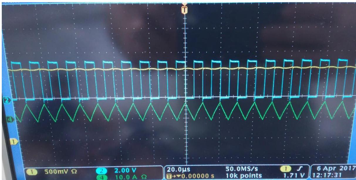
Figura 53. Resultados obtenidos del convertidor *buck* con un ciclo de trabajo del 50% de las señales de *control\_buck* (azul), tensión de salida (amarillo) y corriente de la bobina (verde).
