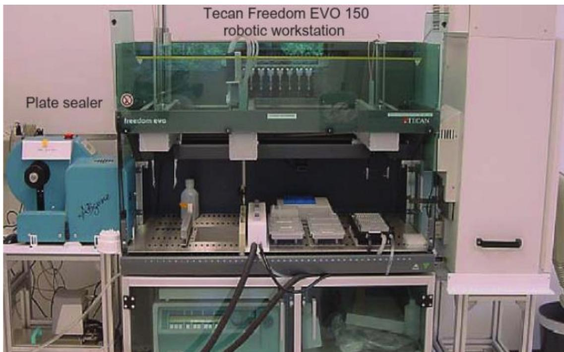
Figura 7. Estación de trabajo robótica Tecan Freedom EVO 150, usada en la preparación de muestras para electroforesis capilar<sup>5</sup>.
