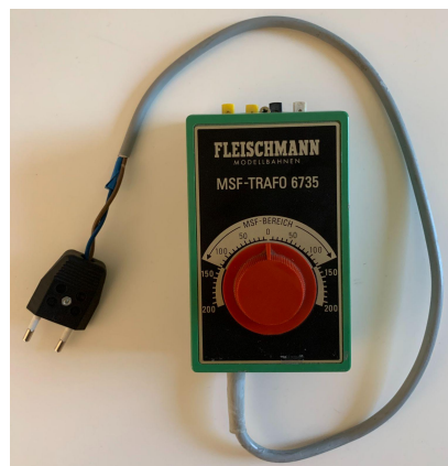
Fotografia 26: transformador 0 V - 17,70 V (font pròpia)
