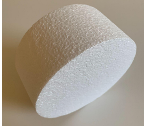
Fotografia 17: cilindre de poliestirè 150 mm (mil·límetres) x 150 mm x 7 mm (font pròpia)
