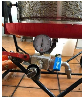
Imatges 18,19,20. Connectar la mànega d'aigua a la premsa i iniciar el premsat que tindrà lloc entre 0 i 3 bars de pressió. Recollir el most que surt de la premsa amb un cubell. Font: Pròpia
