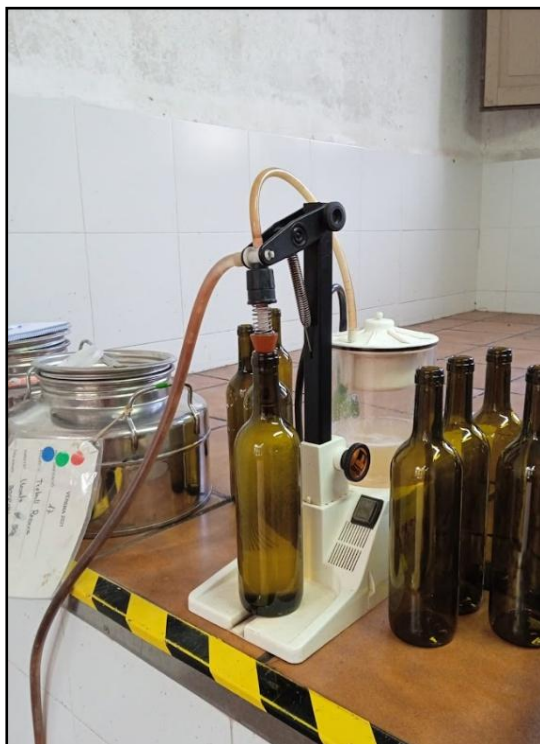
Imatge 68. Màquina per a l'embotellament d'ampolles de vi. Font: Pròpia.
