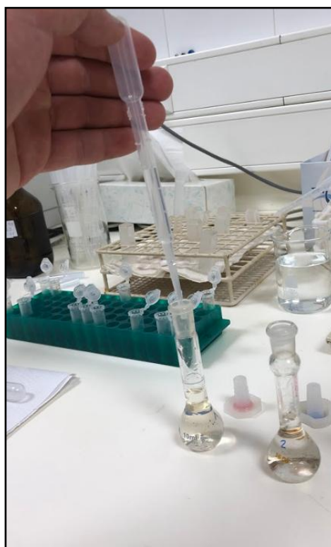
Imatge 56. Enrasar el matràs amb aigua desionitzada utilitzant una pipeta Pasteur per a tenir la dilució 1:10. Font: Pròpia.
