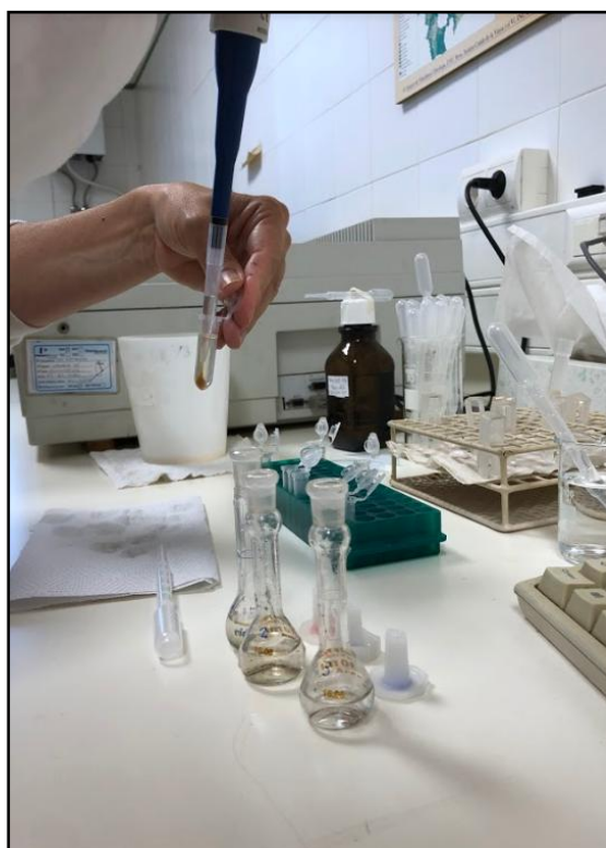
Imatge 55. Pipetejar mitjançant una pipeta electrònica 10 mL de mostra centrifugada dins el matràs aforat. Font: Pròpia
