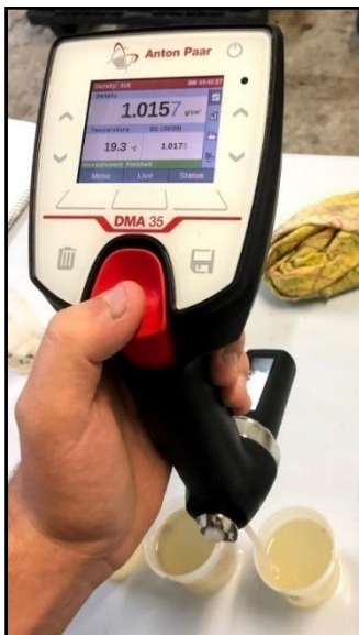
Imatge 42. Introduir el tubet dins un dels vasos, pressionar la tija, deixar anar poc a poc, esperar a que marqui una lectura clara. Font: Pròpia
