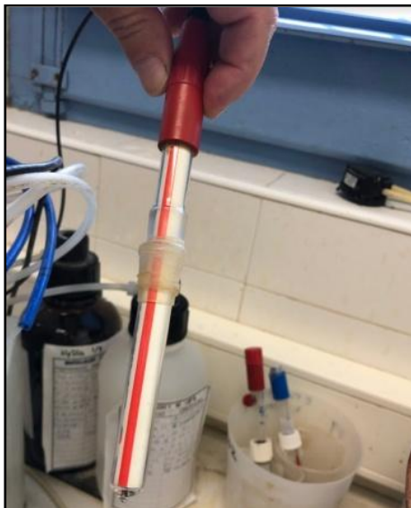
Imatge 47. Elèctrode combinat utilitzat per a la mesura de pH. Font: Pròpia
