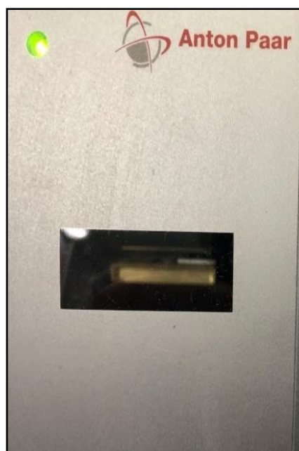
Imatge 62. Part de la U de vidre del densímetre on hi entra el vi per mirar la seva densitat. Font: Pròpia.
