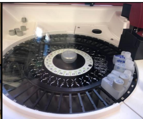
Imatge 72. Interior del MIURA 200. Tambor on al centre s'hi col·loquen els vasis de vidre i pots blancs on hi ha els reactius. Font: Pròpia
