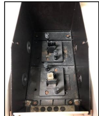
Imatge 54. Part interior del espectrofotòmetre on s'hi col·loca la cubeta. Font: Pròpia
