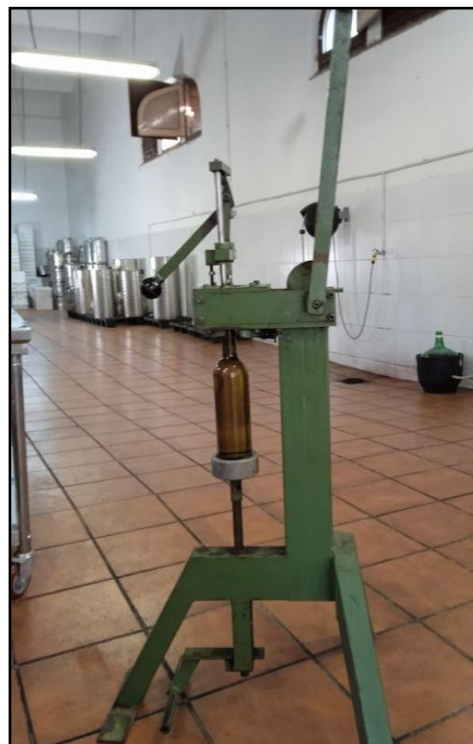
Imatge 69. Màquina per a taponar les ampolles de vi. Font: Pròpia
