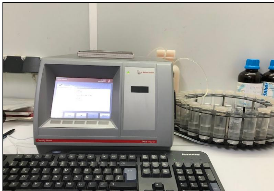
Imatge 60. Densímetre emprat per a trobar els valors dels graus alcohòlics adquirits de cada vinificació i per a mesurar les seves corresponents densitats. El densímetre es troba dins una càmera a 20°C. Font: Pròpia
