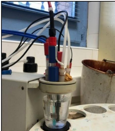
Imatge 45. Mostra sent valorada. S'hi pot veure l'electròde que mesura el pH i els tubs dels reactius que pot injectar el potenciòmetre segons l'anàlisi que es vulgui realitzar. Font: Pròpia.
