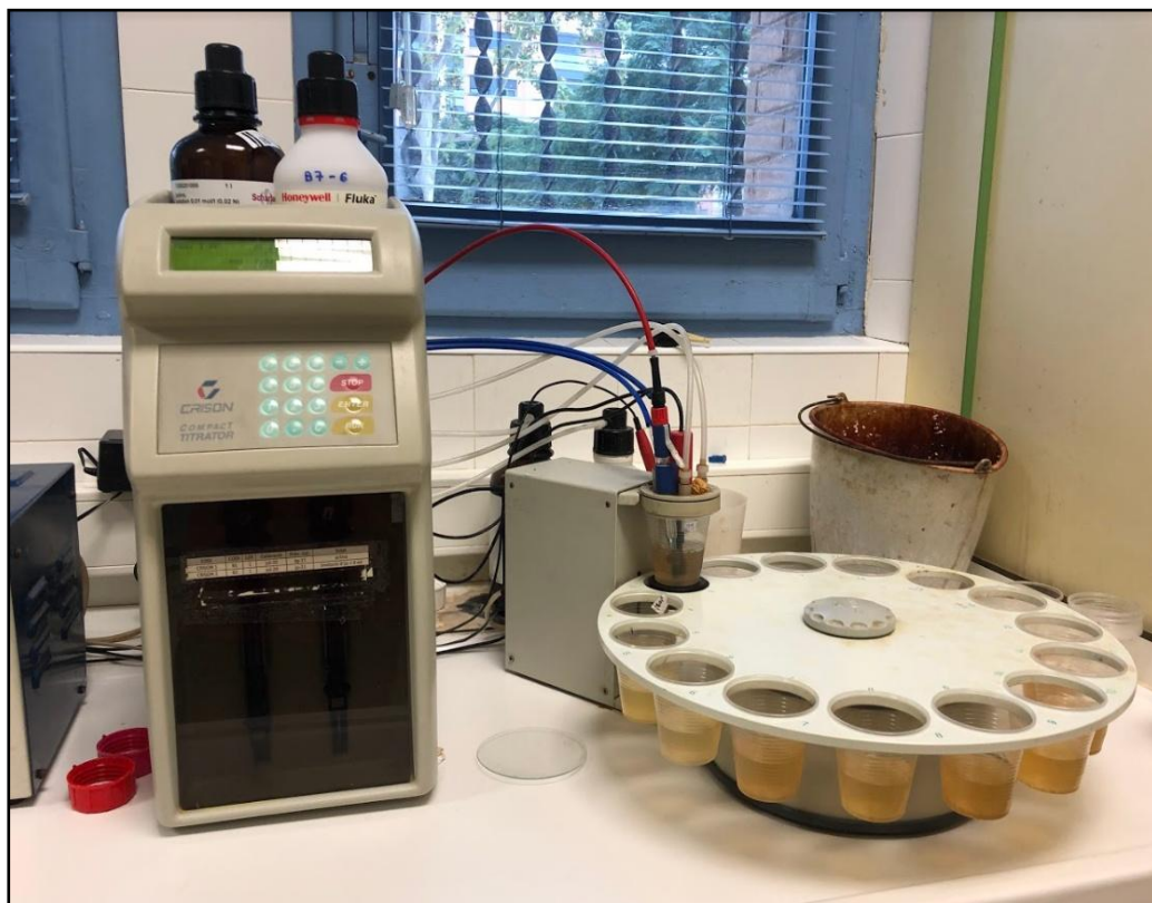
Imatge 44. Potenciòmetre CRISON utilitzat en aquesta pràctica. S'hi veu el tambor ple de vasos per analitzar i com agafa un dels vasos, l'aixeca i comença l'anàlisi que s'hagi introduït en el programa. Font: Pròpia
