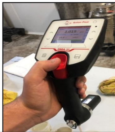
Imatge 27: Mesurar el valor del grau Brix amb el mesurador electrònic. Font: Pròpia
