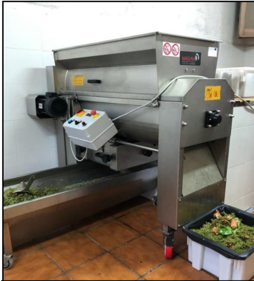
Imatge 16. Màquina per a desrapar la qual permet separar el gra de la raspa i les fulles. Font: Pròpia
