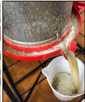
Imatges 18,19,20. Connectar la mànega d'aigua a la premsa i iniciar el premsat que tindrà lloc entre 0 i 3 bars de pressió. Recollir el most que surt de la premsa amb un cubell. Font: Pròpia
