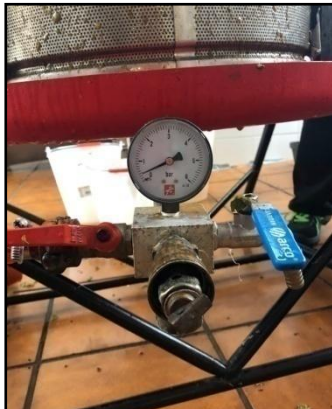
Imatges 18,19,20. Connectar la mànega d'aigua a la premsa i iniciar el premsat que tindrà lloc entre 0 i 3 bars de pressió. Recollir el most que surt de la premsa amb un cubell. Font: Pròpia
