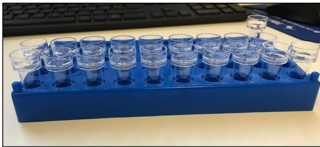
Imatge 74. Vasos de vidre utilitzats per a les anàlisis amb el MIURA 200. Font: Pròpia
