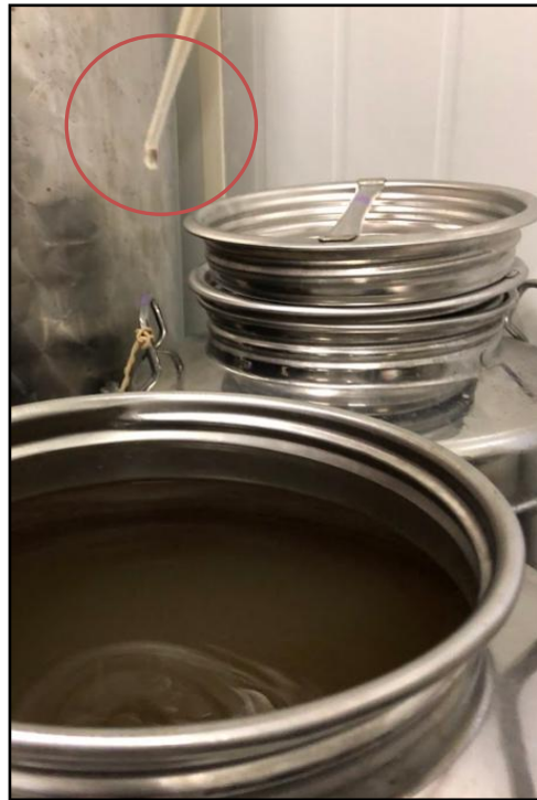
Imatge 32. Afegir amb una pipeta el volum d'enzims en dissolució calculat anteriorment. Font: Pròpia
