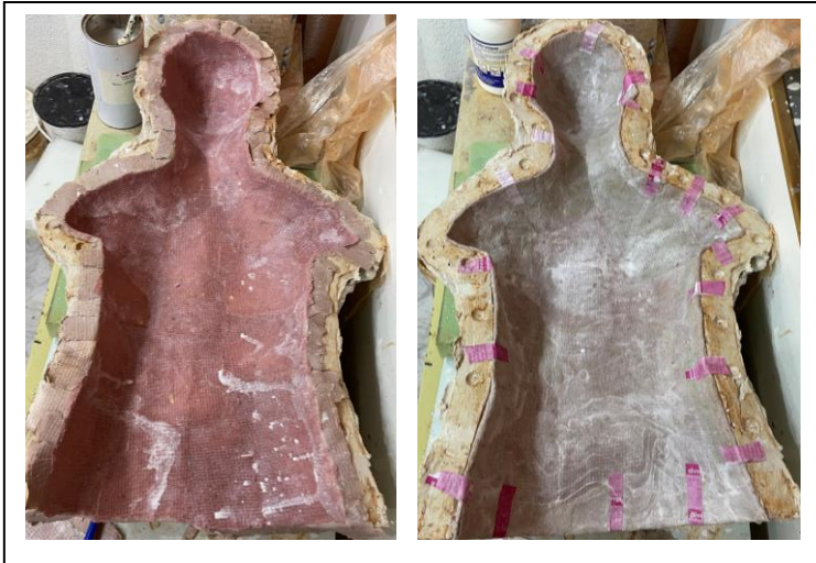
Fig. 12. Figura amb cartró pedra en el motlle.
