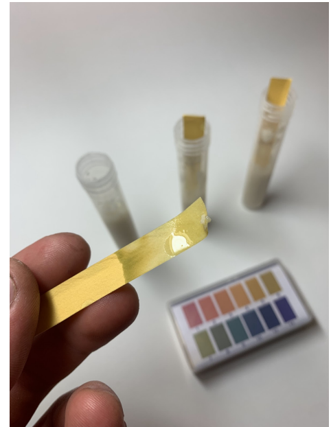
Figura 27: Realitzant l'anàlisi de l'acidesa per mirar el pH dels pans a partir de les tires reactives de pH
