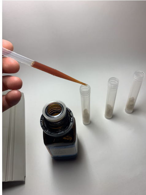
Figura 25: Realitzant l'anàlisi del midó als pans a partir del reactiu de Lugol
