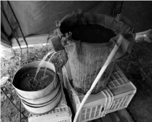
Figure 16.3. Machine à flottation. Cuve à maille intérieure de 1 mm et, à l'extérieur, colonne de tamis à maille décroissante, de 5/4 et 0,5 mm.
