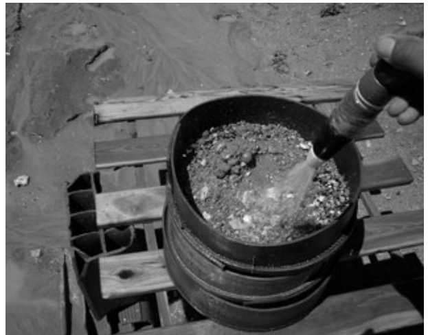
Figure 16.7. Détail du lavage des sédiments au moyen de la colonne de tamis de 5/4, 1 et 0,5 mm à l'aide d'un tuyau.
