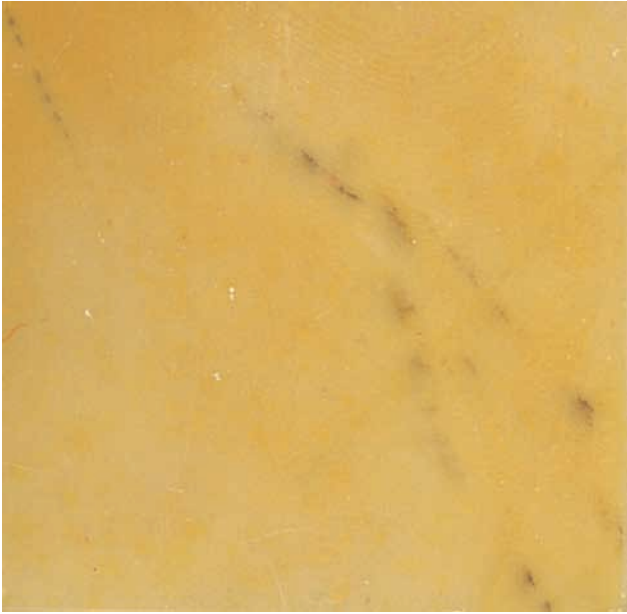
Figura 17. Aspecte macroscòpic del «giallo di Siena». Figure 17. Macroscopic appearance of giallo di Siena . Foto | Photo: A. Álvarez.
