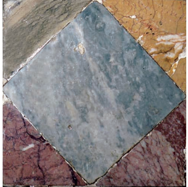
Figura 28. Detall d'un dels quadres de l' opus sectile de Can Peixau de Badalona amb pedra de Santa Tecla (Museu de Badalona, núm. d'inventari 11.545). Figure 28. Part of one of the opus sectile squares of Can Peixau, Badalona with Santa Tecla stone (Museu de Badalona, inventory number 11.545).
