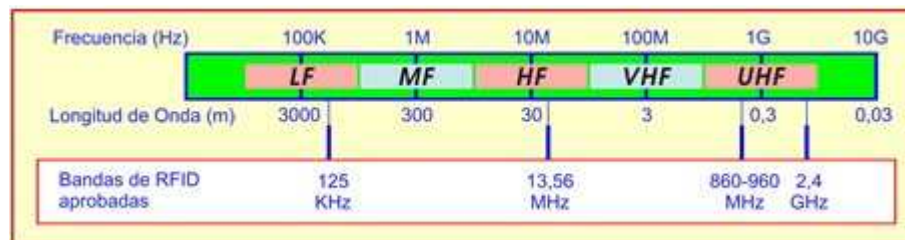
Figura 1.1. Rango de frecuencias de trabajo de RFID
