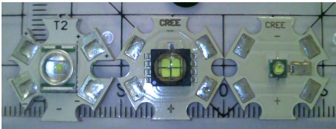
Figura 27. PCB de aluminio para mejor disipación de temperatura de los HBLEDs XR-E MC-E XP-E
