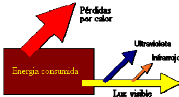
Figura 8. Balance energético de una lámpara genérica
