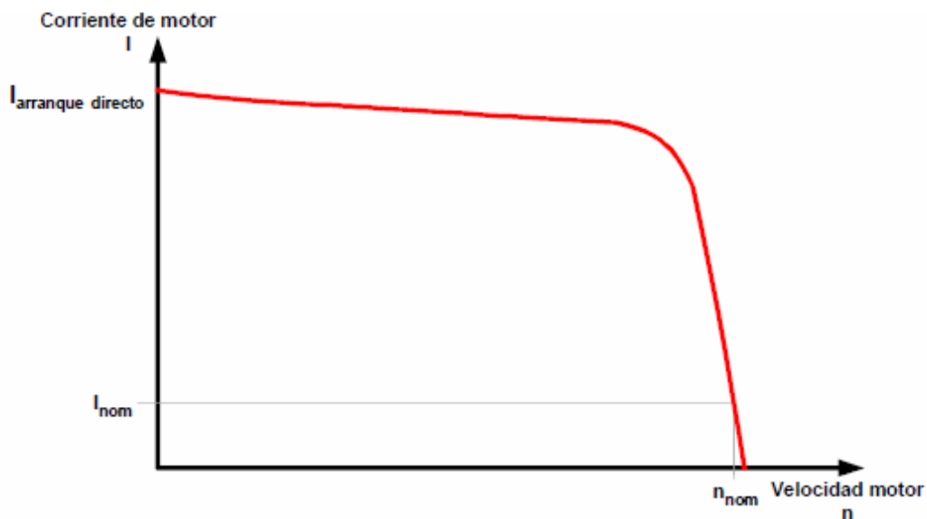
Figura 20: Característica típica corrent d'arrencada motor asíncron trifàsic.
