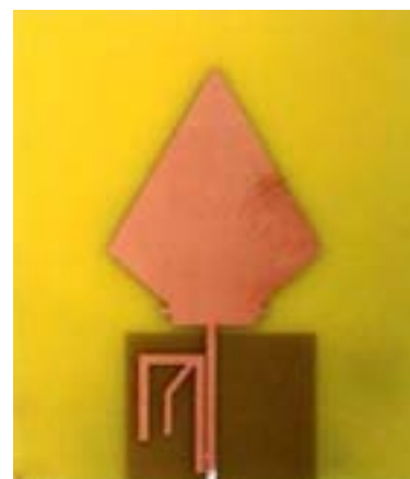
Figura 6.8 – A l'esquerra : mesura de l'adaptació de l'antena 3 amb ressonador stub . A la dreta: imatge de l'antena 3 amb ressonador stub ..
