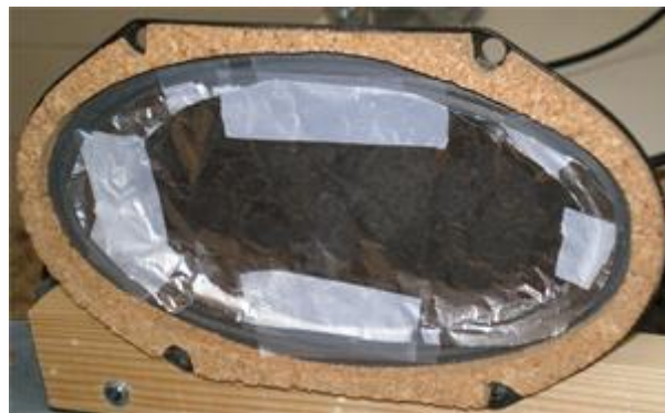
Figura 3.21. Vista del blanco, consistente en un altavoz recubierto de papel de aluminio para aumentar su sección recta. Este blanco replicará el corazón humano, en las medidas en las cuales se requiere de precisión en la distancia radar-blanco.
