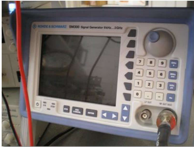
Figura 8.11. Generador de funciones utilizado como oscilador local para el sistema radar, en todas las topologías. Cobra mayor importancia en esta topología puesto que se debe controlar remotamente para variar la frecuencia.
