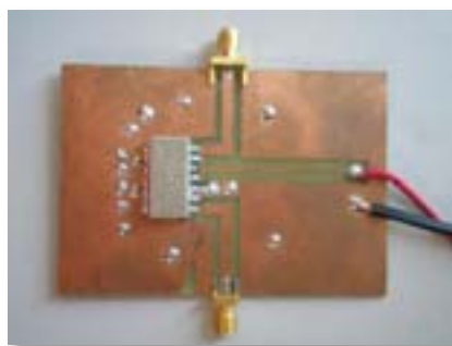
Figura 7.13. Fotografía de la placa que contiene el chip desfasador ya soldado, y con los cables para los accesos de control ( V_{CTRL} ).
