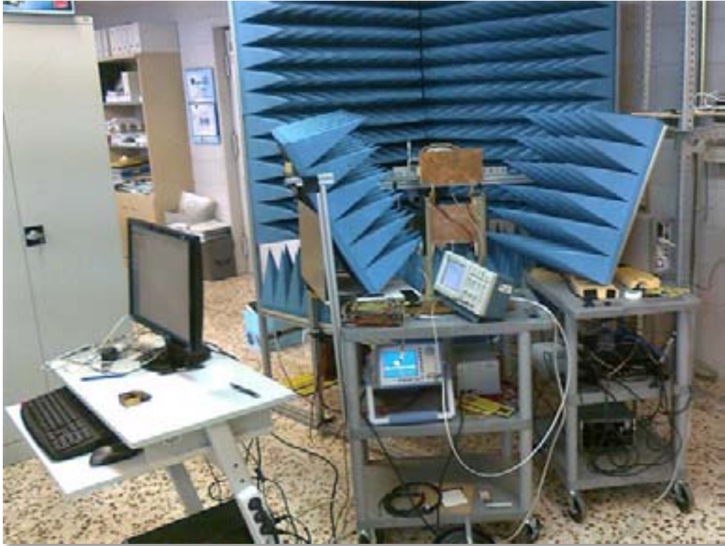
Figura 3.23. Fotografía del montaje de la topología con líneas desfasadas, vista general. A la izquierda de la fotografía se puede observar el PC encargado de capturar los datos y procesarlos. Véase también todo el recubrimiento de antenas y blanco con absorbente de microondas de color azul. En el carrito del centro de la fotografía también se puede ver el osciloscopio de referencia (parte superior del carrito) y el generador de funciones para OL (parte inferior del carrito).
