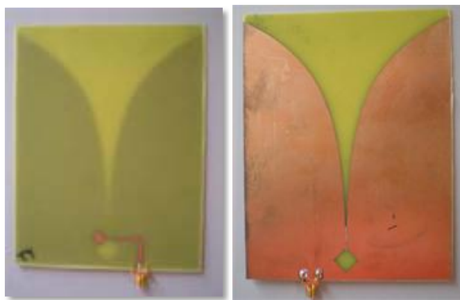
Figura 8.10. Antena Vivaldi de banda ancha. Cara anterior y posterior.
