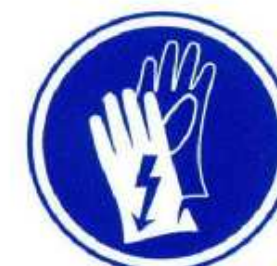
Ús obligatori de guants dielèctrics
