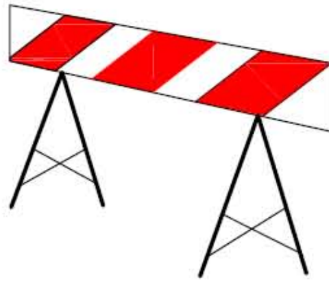
Barrera metàl.lica (desviament trànsit)
