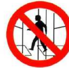
Prohibit el pas bastida incompleta
