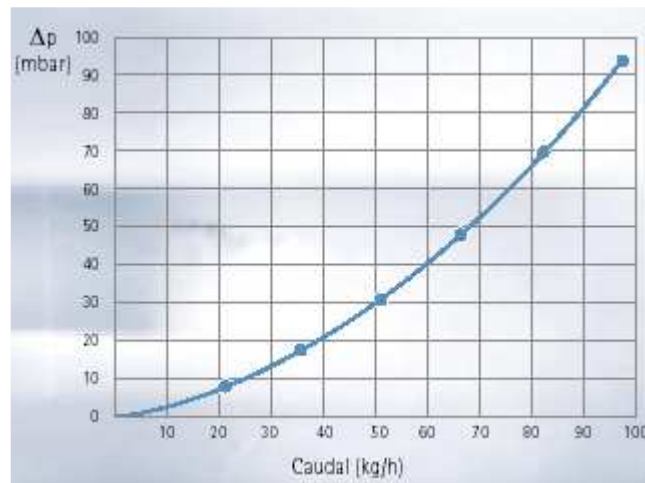
Figura 31. Corba de pèrdua de càrrega dels panells solars.
